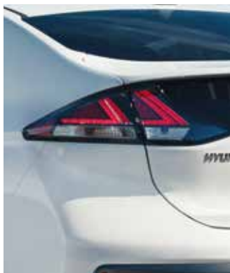
Blocuri optice spate
