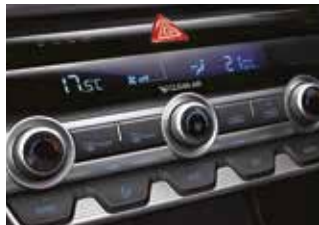
Sistem automat de climatizare
