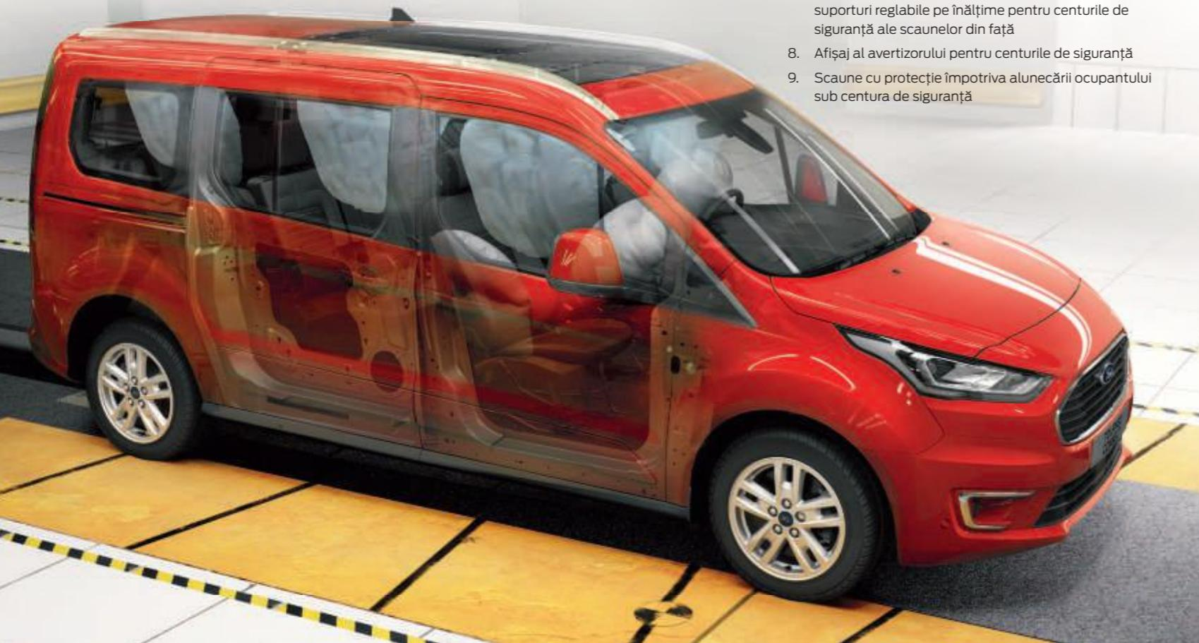
Cu o clasificare NCAP de 5 stele, sistemul inteligent de protecție (IPS) avansat<sup>①</sup> al Ford Tourneo Connect folosește o gamă de tehnologii sofisticate pentru a vă proteja, inclusiv o carcasă de protecție din oțel cu rezistență ultra-ridicată, un sistem de antiblocare a roțiilor la frânare cu asistență la frânarea de urgență și airbaguri frontale, laterale și tip cortină.
